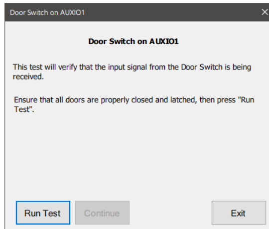
Door Switch Test
